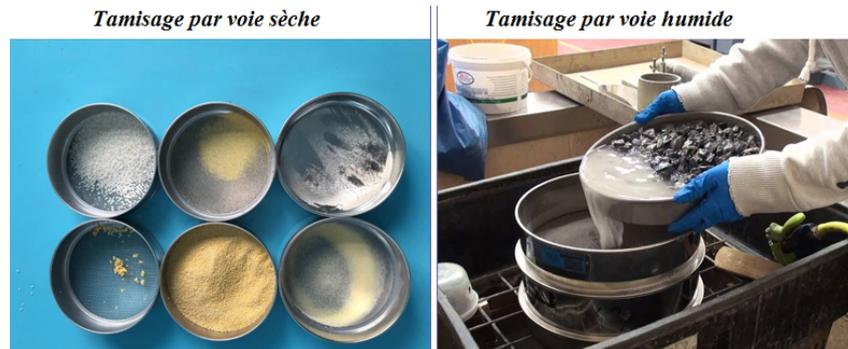
Figure 2-7: Tamisage par voie sèche et humide. ([www.dahanmachine.com](http://www.dahanmachine.com))
