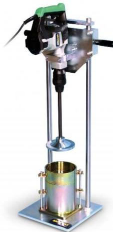
Figure 3-12 : marteau de compactage vibrant. (www.stde.fr).
