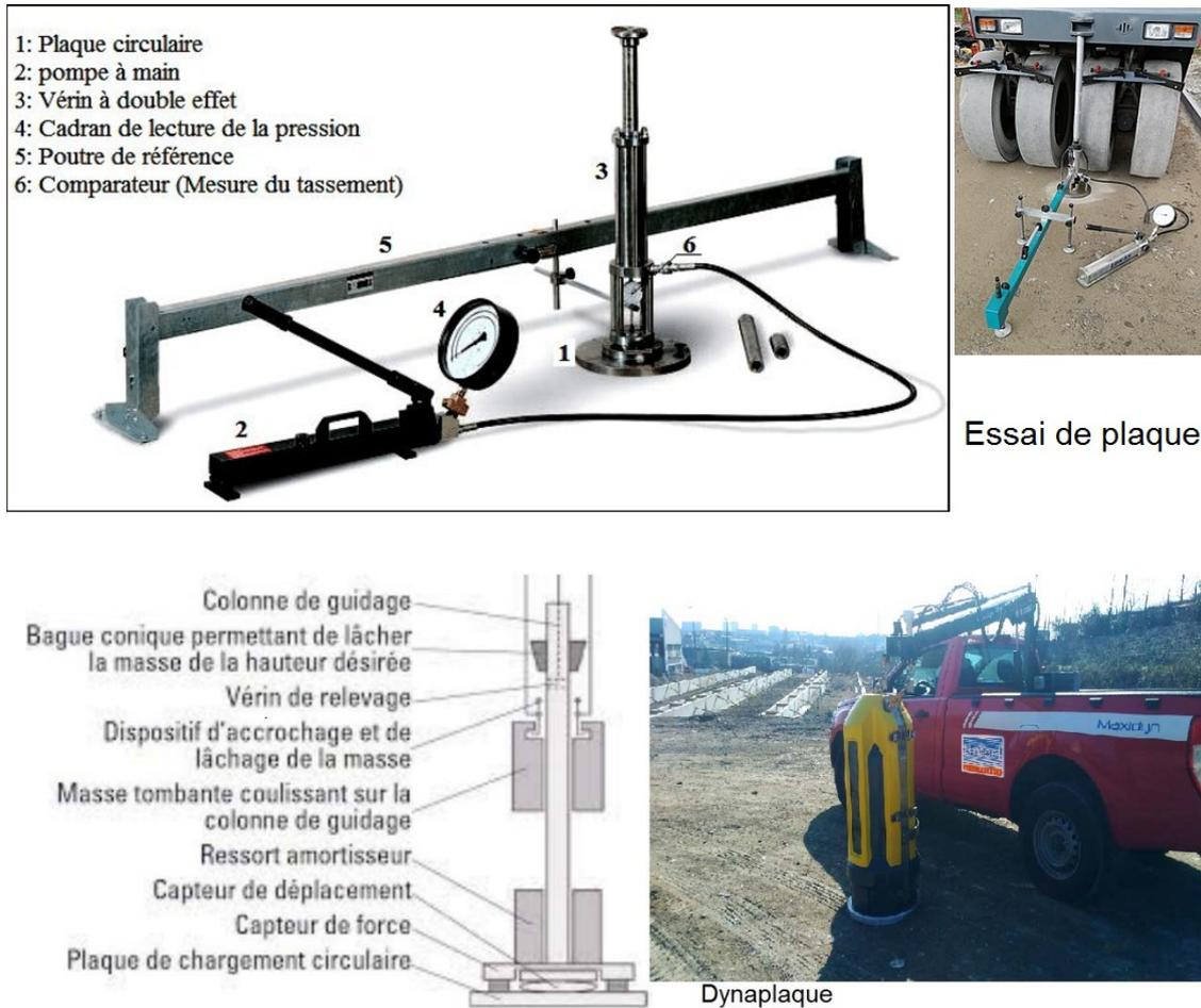
Figure 3-24: différentes méthodes de contrôle de la qualité du compactage. [www.vectra.com](http://www.vectra.com) ; [www.wikipedia.com](http://www.wikipedia.com).
