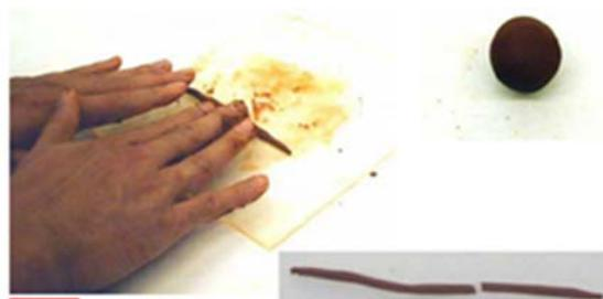
Figure 2-16: Détermination de la limite de plasticité.
